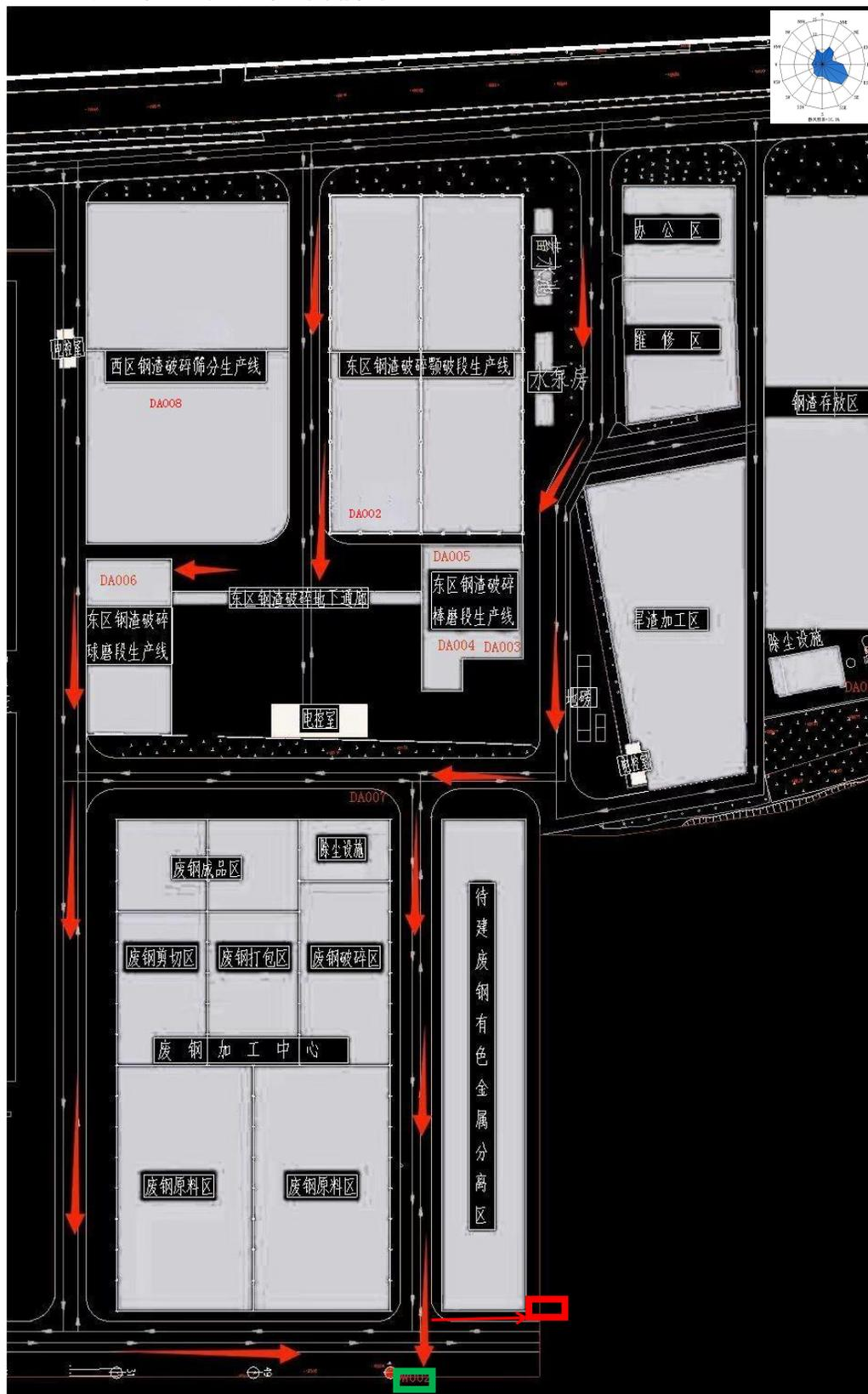
→ : 雨水、事故水管线;    □ : 雨水排放口;    □ : 事故水池
